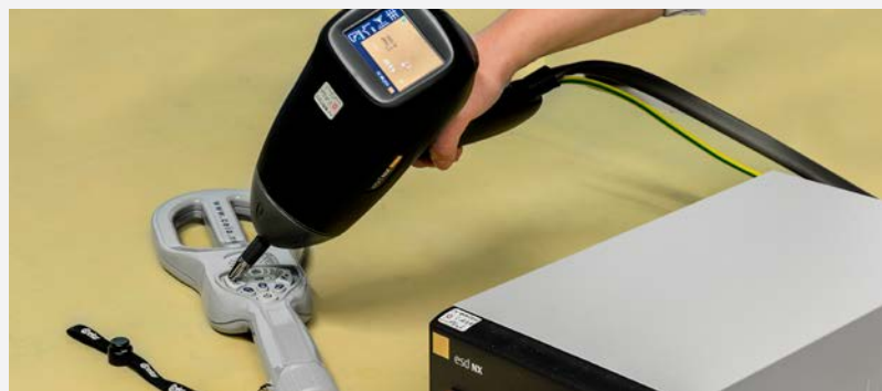
TEST D'IMMUNITÉ AUX DÉCHARGES ÉLECTROSTATIQUES
