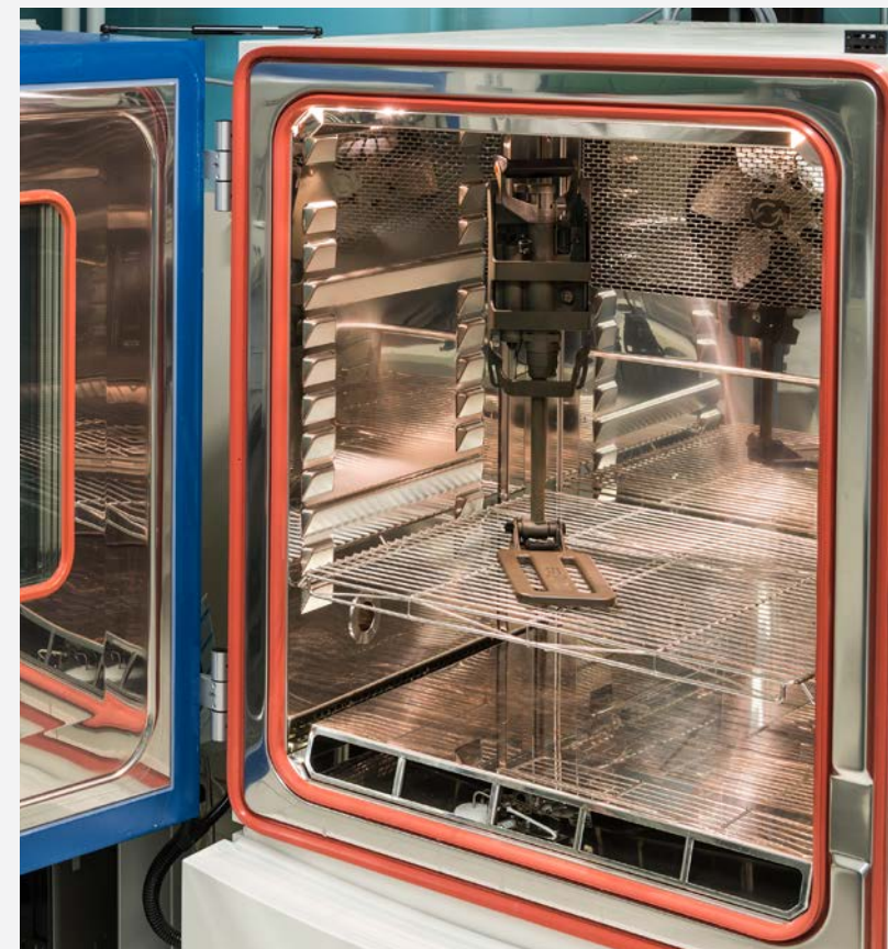
TESTS DE RÉSISTANCE A L'ENVIRONNEMENT, CONDITIONS DE TEMPÉRATURE ET D'HUMIDITÉ RELATIVE
